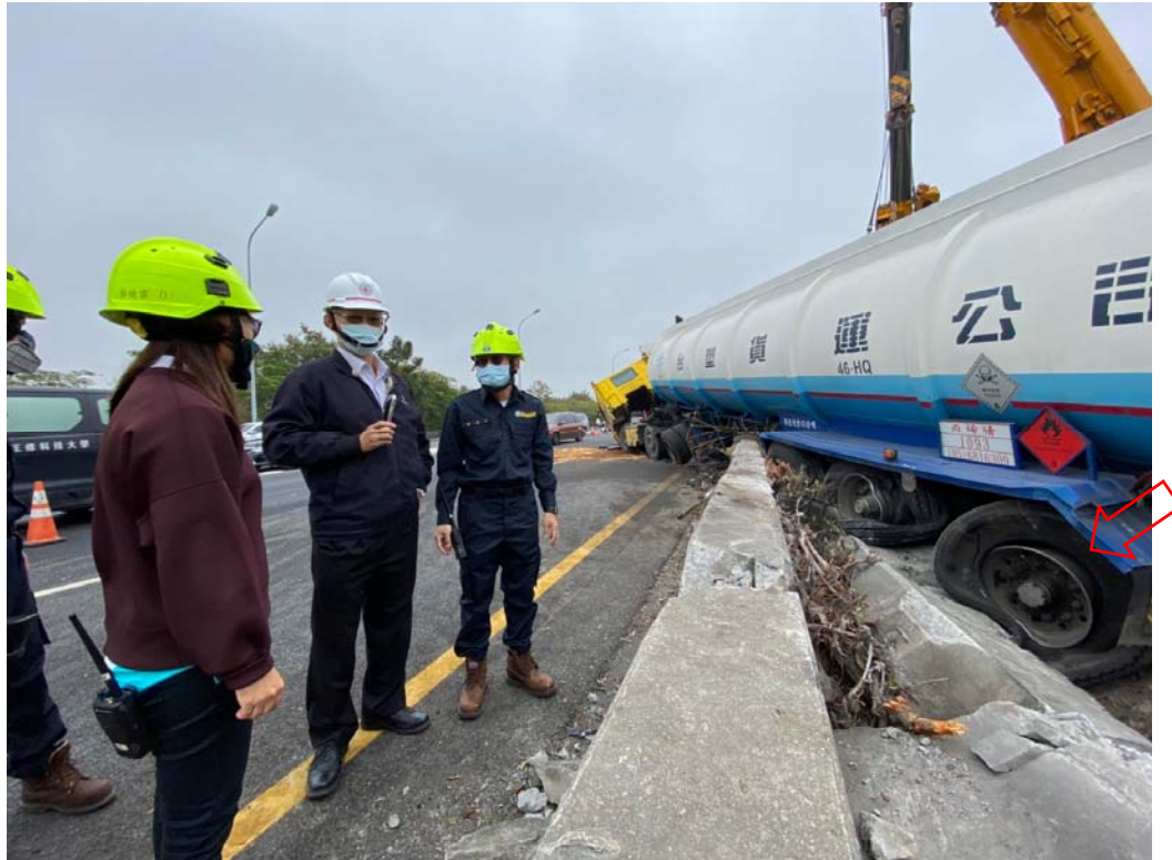
槽體左後二車輪全破
