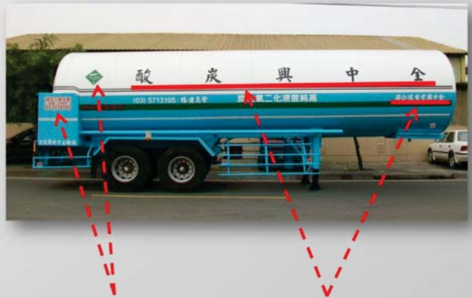
危險物品標誌 公司名稱 及標示牌
